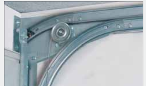
Laag lateibeslag met achterliggende veeras, vanaf 250 mm bovenruimte.
